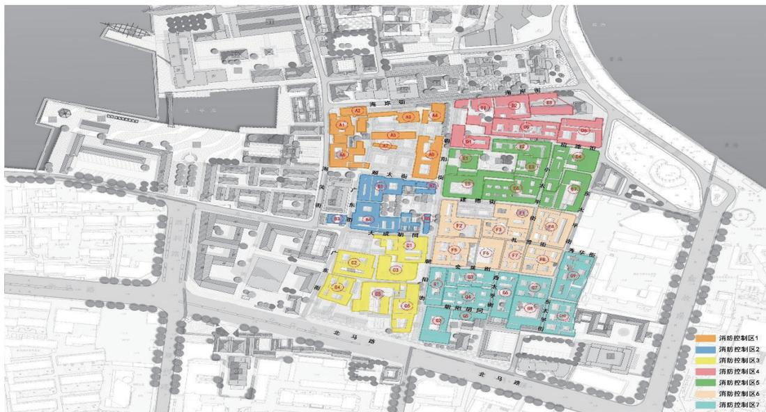
图 6-11 防火控制区及防火组团示意图
