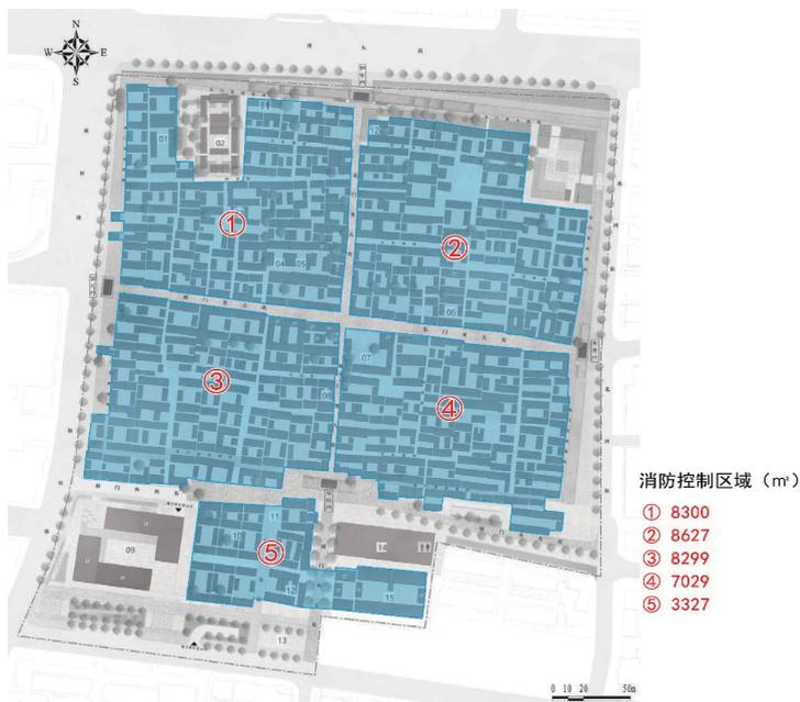
图 7-9 防火控制区及防火组团示意图
