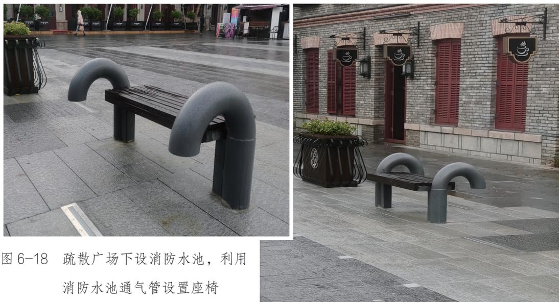
图 6-18 疏散广场下设消防水池，利用消防水池通气管设置座椅
